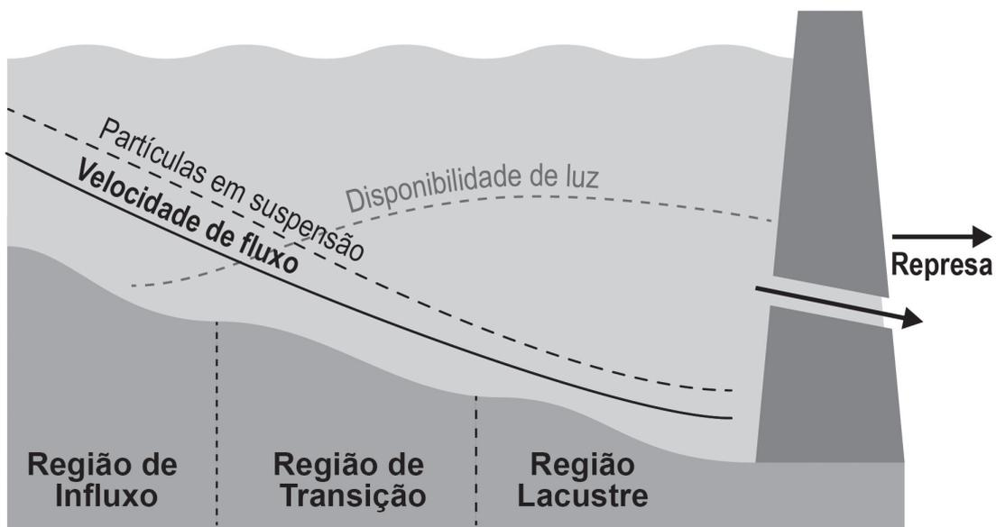
**Figura 46** – Partículas em suspensão, velocidade de fluxo e disponibilidade de luz no gradiente longitudinal de reservatórios. (Modificado de KIMMEL et al., 1990). Adaptado por Ricardo Degani & Tundisi, 2021.
