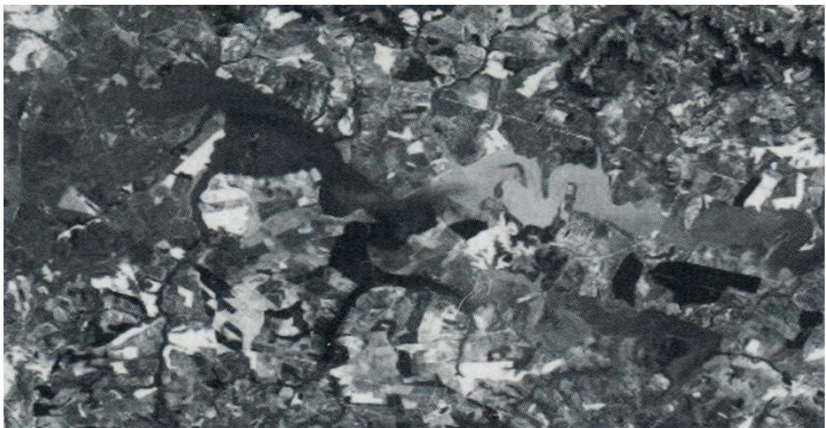
**Figura 83** – Imagem de satélite da Represa de Barra Bonita e o impacto de material em suspensão devido à drenagem da bacia hidrográfica durante períodos de intensa precipitação; as áreas mais claras indicam acúmulo de material em suspensão. Fonte: Acervo de imagens IIE.
