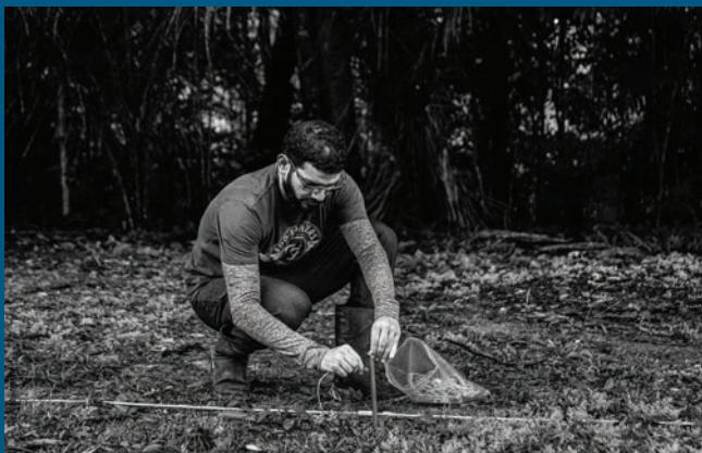
Instalação de eletrodos para levantamento de tomografia elétrica (ERT) aplicada ao monitoramento de recarga artificial do aquífero Alter do Chão na área da Reserva Florestal Adolpho Ducke - Manaus.
