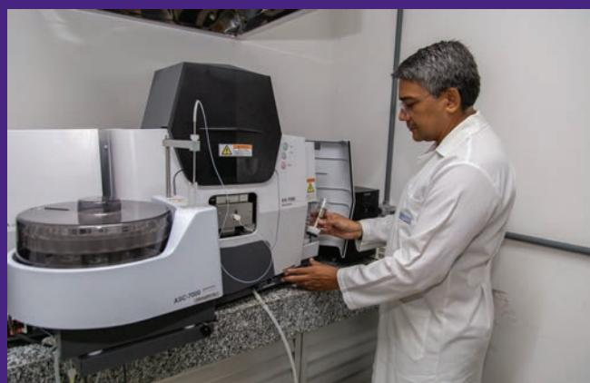
Análise de metais pesados em amostra de água, utilizando o equipamento espectrômetro de absorção atômica no Laboratório de Química Ambiental do INPA.
