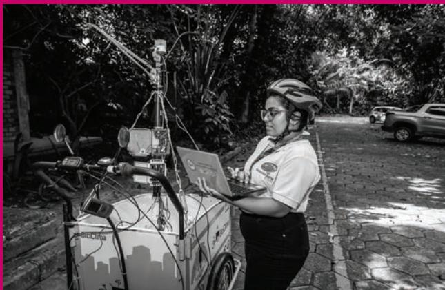
Coleta de dados de temperatura da superfície utilizando a Biciclima.
