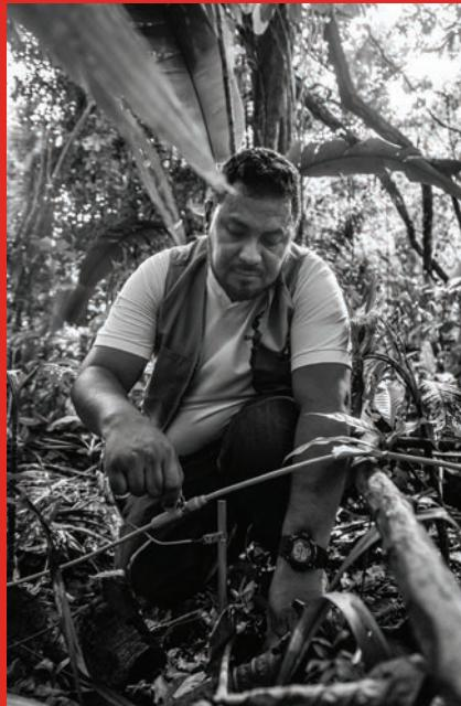
Fixação de hastes metálicas para distribuição de corrente elétrica através do equipamento de eletrorresistividade.
