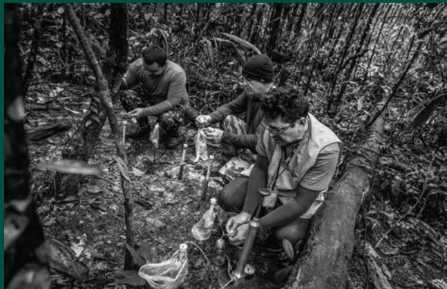
Aplicação de vácuo através da Bomba de vácuo para obtenção da água do solo via extratores.
