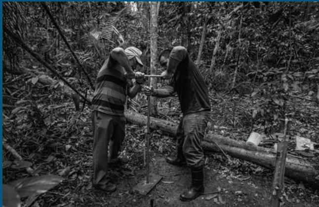
Instalação de extratores de solução do solo em experimentos para acompanhar o comportamento dos nutrientes na área de injeção no Bosque da Ciência/ INPA CAMPUS I.
