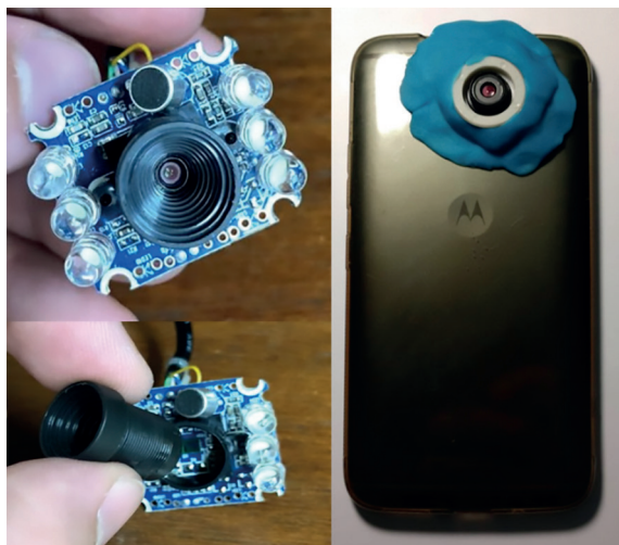
Figura 3 – Modelo de microscópio artesanal construído com lente de webcam acoplada ao celular com massinha de modelar.
